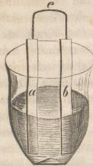
Chlorammonium (Salmiak) gestellt, so macht sich keine Veränderung bemerkbar, werden aber beide Metalle durch einen Metalldraht *c* in Verbindung gesetzt, so bemerkt man sogleich eine Wasserzersetzung, indem Wasserstoff am Silber und Sauerstoff am Zink frei wird; da aber Zink leicht oxydirbar ist, so tritt der freiwerdende negativelektrische Sauerstoff mit dem positivelektrischen Zink zu Zinkoxyd zusammen.
